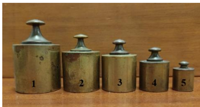
Figura 6.4 - Pesos utilizados com valores conhecidos: 1. 203 g; 2. 128 g; 3. 105 g; 4. 55 g; 5. 20 g
