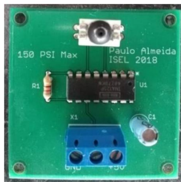
Figura 6.8 - Placa integrada do sensor de pressão usado [114].
