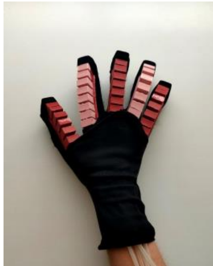
Figura 4.19 - Luva de reabilitação com atuadores pneumáticos em Elastosil® M 4601 A/B [87].
