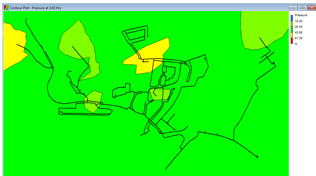
Figura 5.31 – Gráfico de isolinhas de pressão da ZMC de Cacilhas. Segunda solução de otimização de pressões (Extraído do EPANET 2.2).
