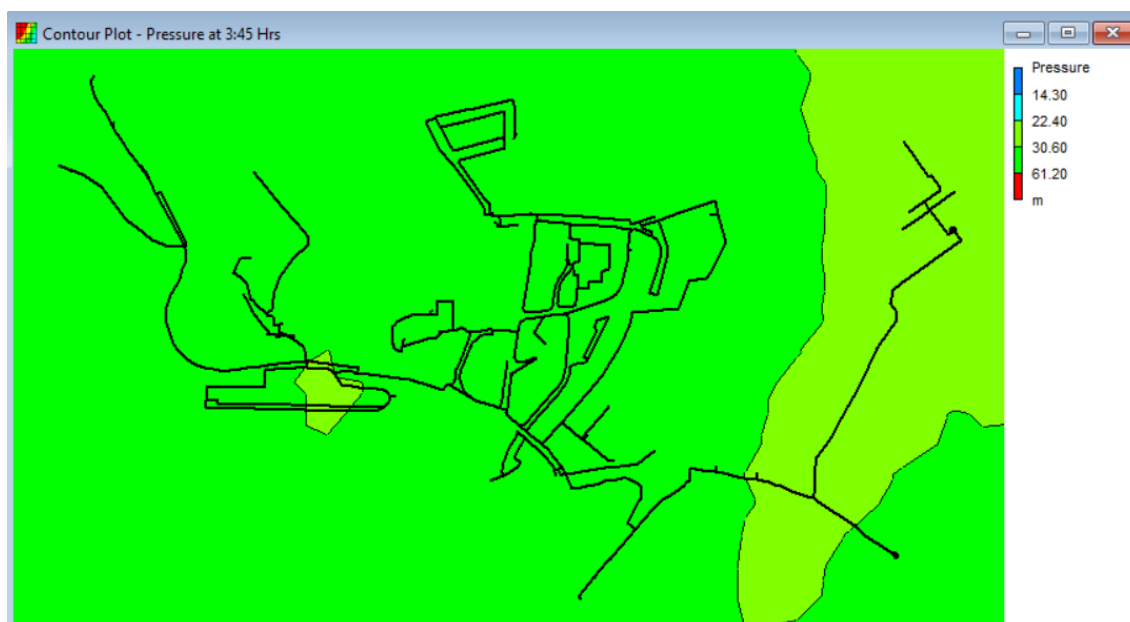
Figura 5.26 – Gráfico de isolinhas de pressão da ZMC de Cacilhas depois da intervenção (modelo de 2022) (Extraído do EPANET 2.2).
