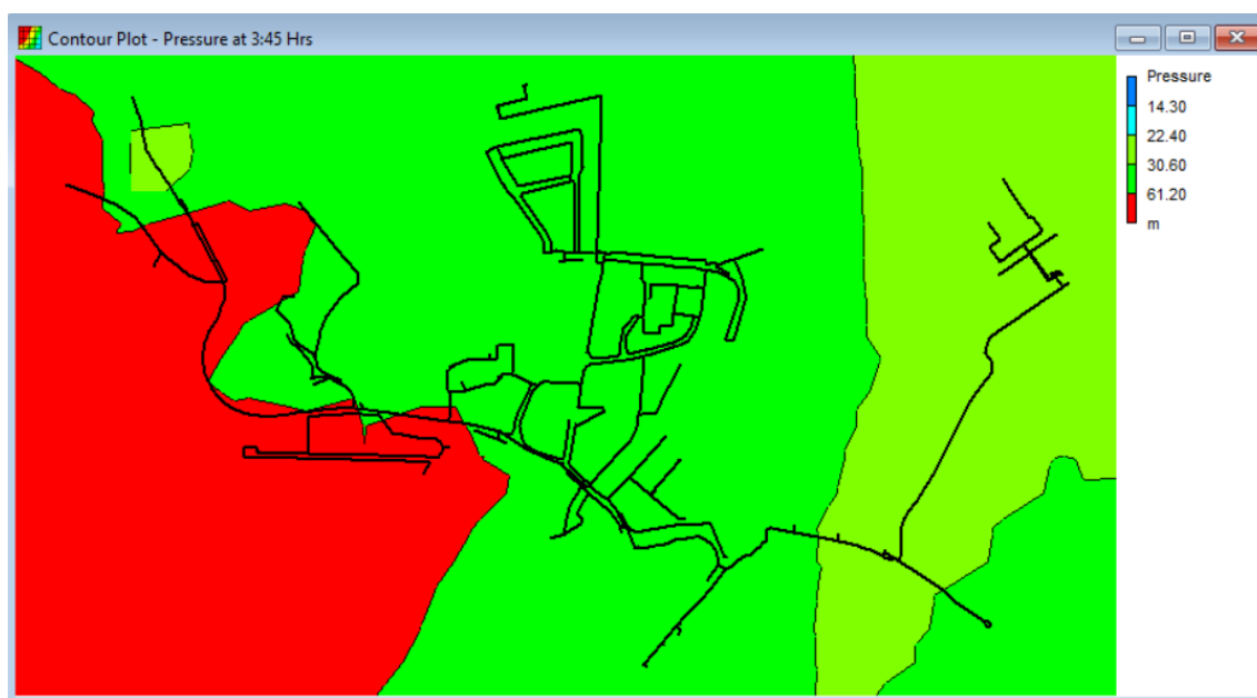
Figura 4.27 – Gráfico de isolinhas de pressão da solução-base do modelo da ZMC de Cacilhas (Extraído do EPANET 2.2).
