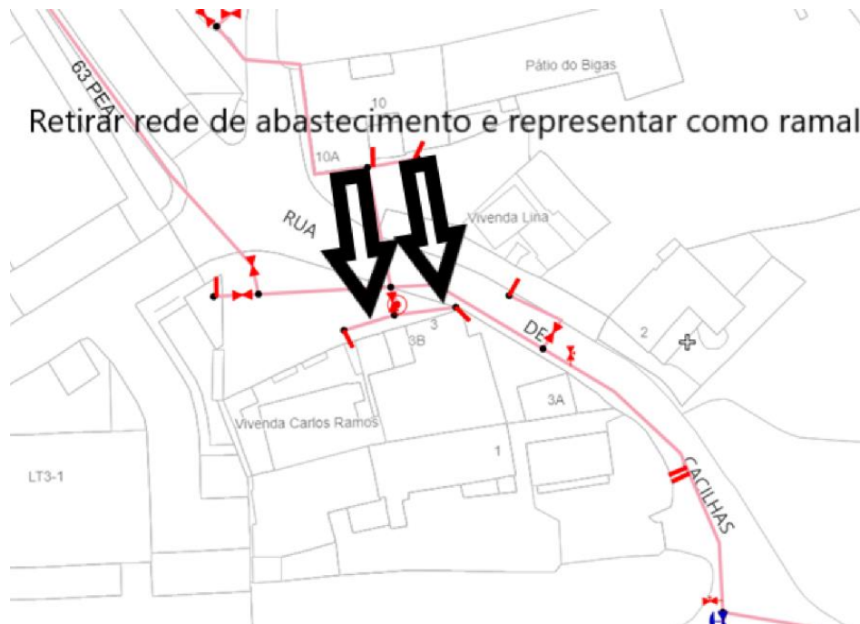
Figura 4.14 – Exemplo de alteração de cadastro efetuado (Extraído do WebSIG).
