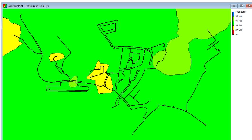
Figura 5.37 – Gráfico de isolinhas de pressão da ZMC de Cacilhas. Terceira solução de otimização de pressões (Extraído do EPANET 2.2).
