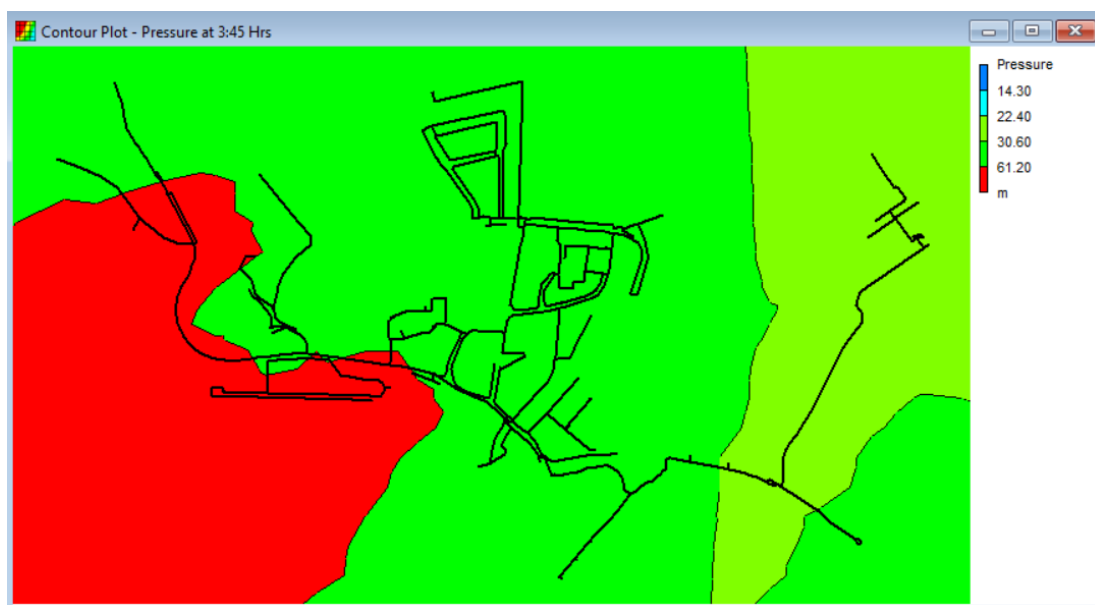
Figura 5.24 – Gráfico de isolinhas de pressão da ZMC de Cacilhas antes da intervenção (modelo de 2019) (Extraído do EPANET 2.2).
