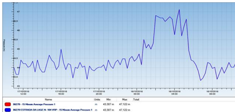
Figura 4.49 – Gráfico de medição de pressão através de data logger do ponto 6 (Extraído do Primayer).
