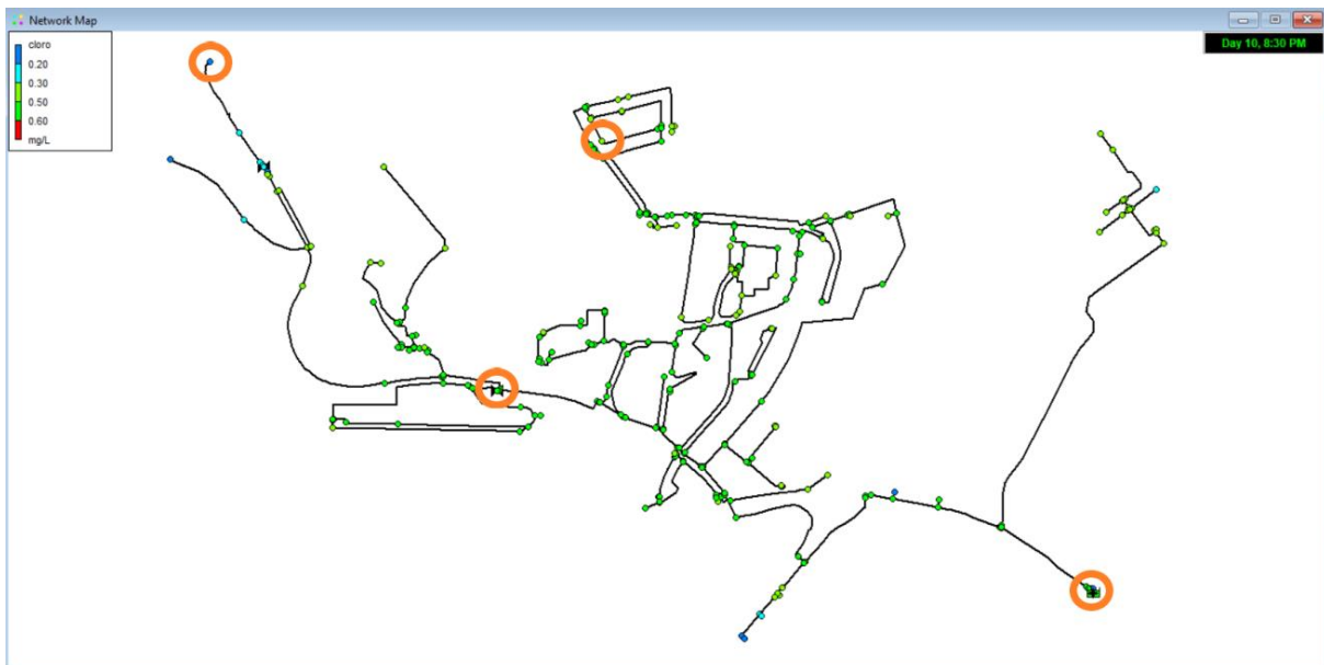
Figura 4.66 – Localização dos pontos de medição de cloro no modelo (Extraído do EPANET 2.2).
