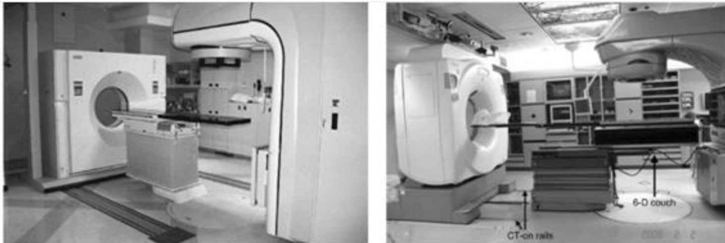
Fig. 16 - Exemplos de sistemas de CT-on-Rails .
