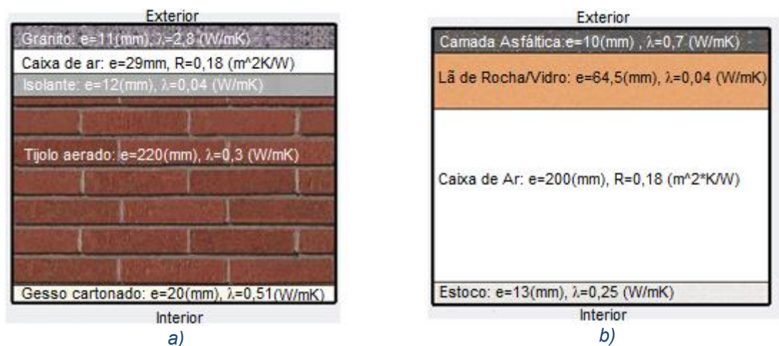
Figura 21 – Localização e configuração das camadas da solução construtiva de referência, exemplo de Lisboa– a) paredes exteriores, b) Cobertura
