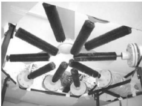
Figura 5 - Tubos impregnados de PCM com ventoinha incorporado (Tumpenny, J.R., & Reay, 2001)
