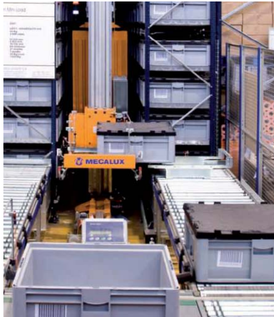
Figura 2.12 - Armazém inteligente, com destaque para o robô transelevador (MECALUX, 2010).
