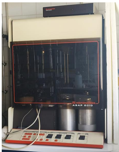
Figura 12 – Equipamento automático usado na realização dos ensaios de adsorção de N 2 a -196 °C.
