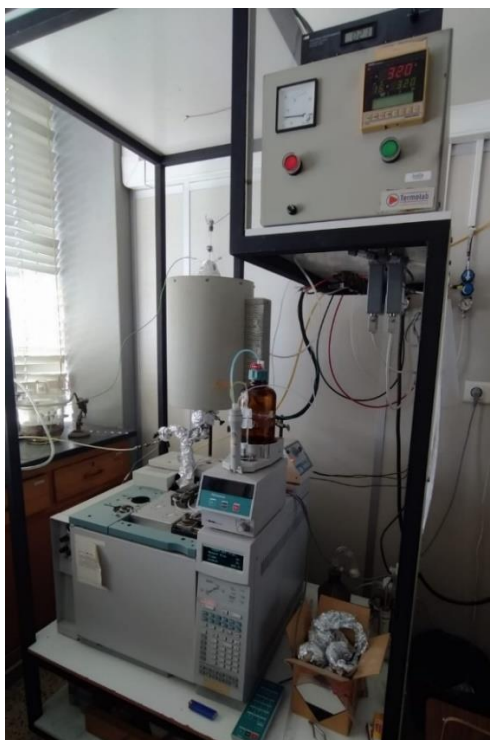
Figura 16 – Instalação usada na realização dos ensaios de hidroisomerização de n -decano.
