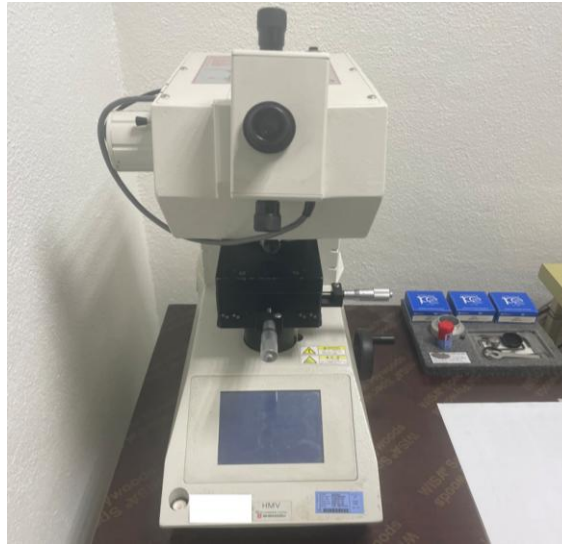
Figura 3.13 – Microdurómetro Shimadzu HMV-2 (por cortesia da OGMA).
