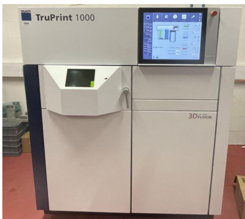
Figura 3.5 – Equipamento de SLM TruPrint 1000 da marca TRUMPF (por cortesia do CDRSP - Leiria).
