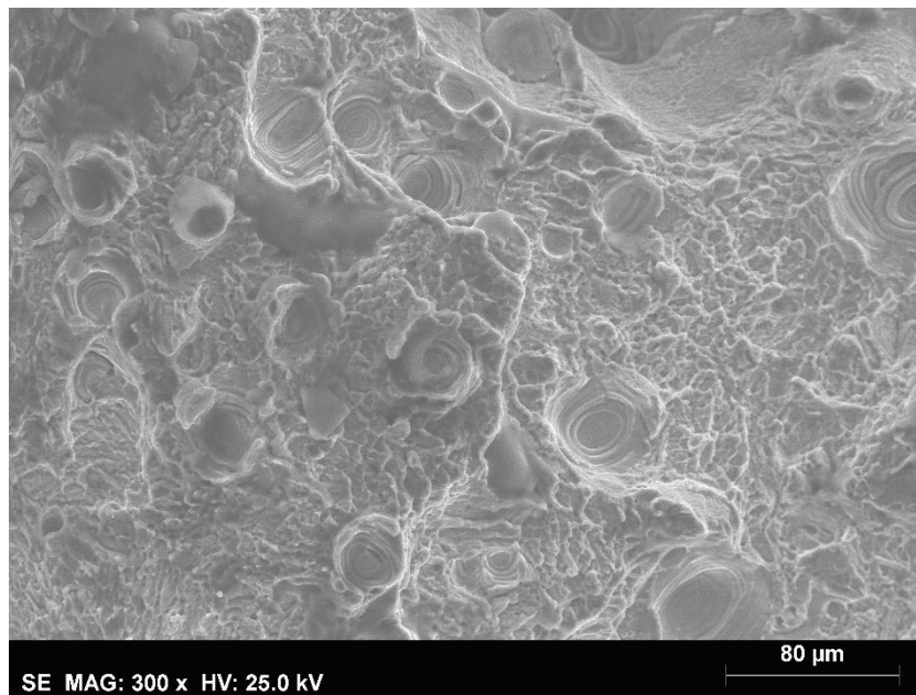
Figura 5.18 – Micrografia SEM da Liga de Ti-6Al-4v – 2º lote, provete fraturado por impacto.
