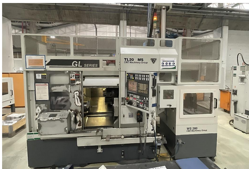
Figura 3.7 - Torno CNC TL20 MS da CMZ (por cortesia da Lauak Portugal).
