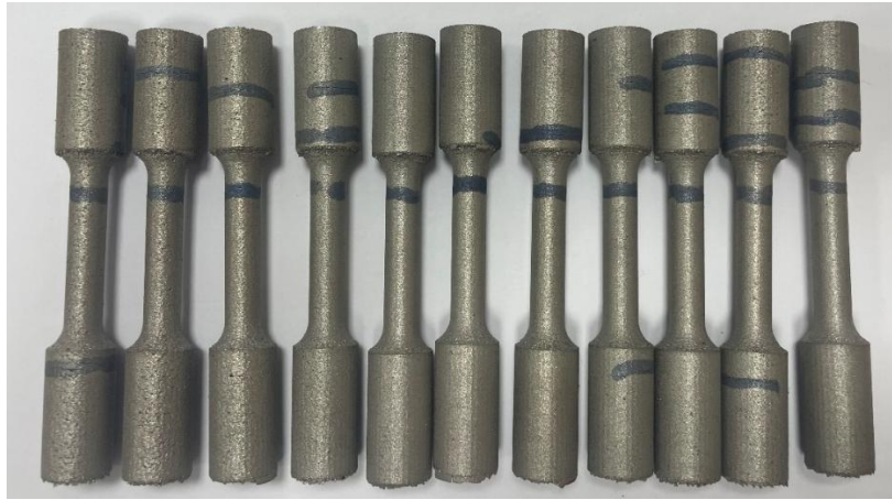
Figura 5.3 – Provete 2º lote, com destaque para os defeitos identificados a azul.
