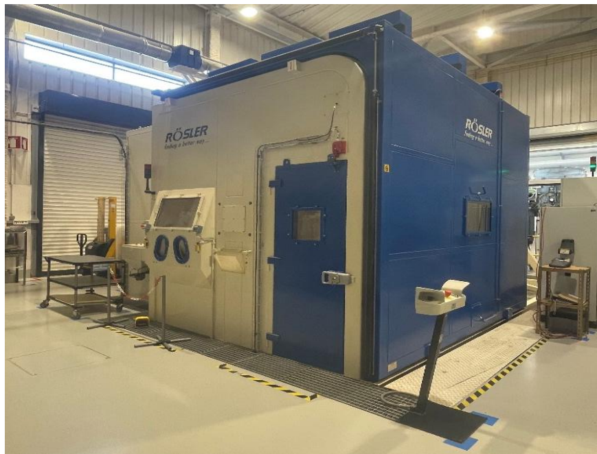
Figura 3.9 - Equipamento de Shot Peening ROSLER - SP 1500 LR G1 (por cortesia da OGMA).
