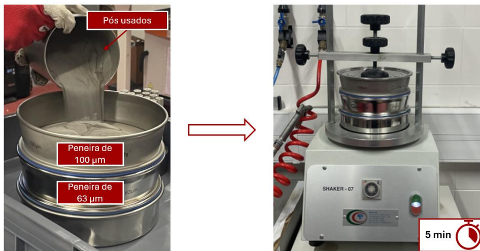
Figura A.3 – Esquema de tratamento dos pós, com recurso a uma peneira.
