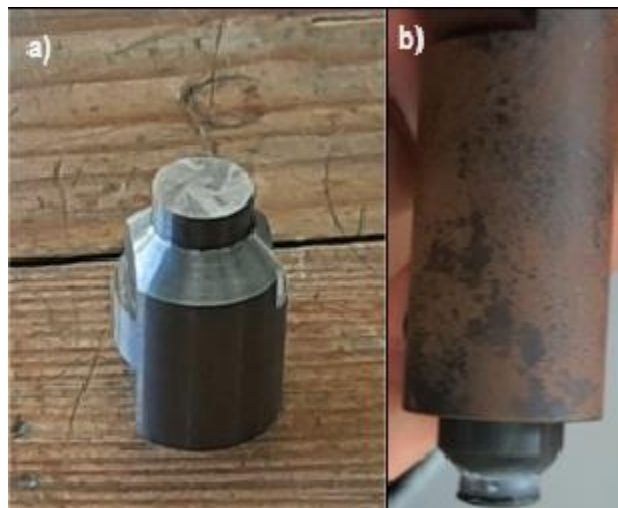
Figura 3.1 - a) Base ( shoulder ) com diâmetro de 10 mm; b) Ferramenta (corpo + extremidade removível).
