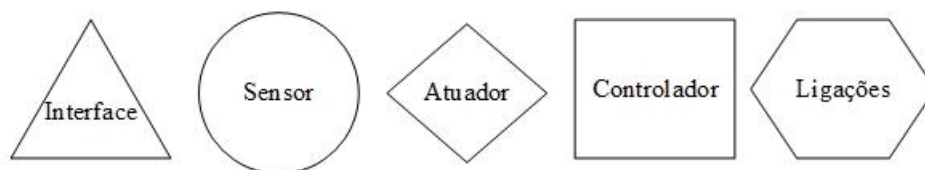
Figura 3.4 – Simbologia dos tipos de componentes típicos em domótica.
