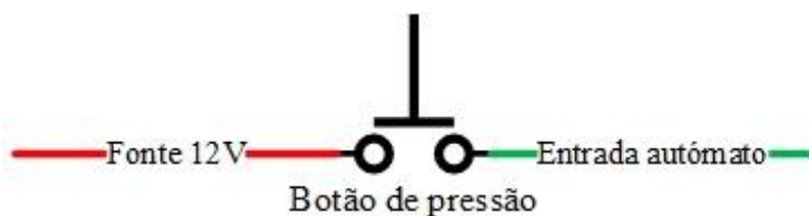
Figura 3.5 – Funcionamento do botão de Pressão
