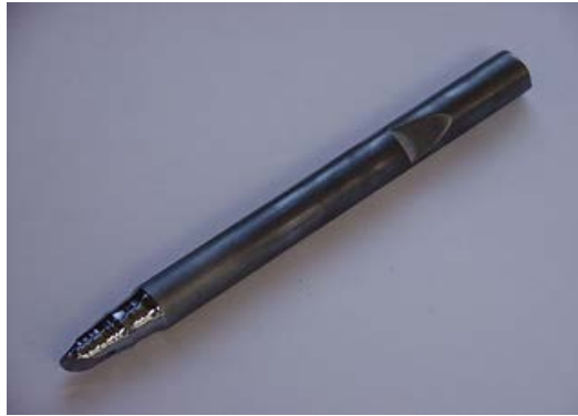
Figura 2.9 - Haste para o cultivo de Silício pelo Processo Czochralski
