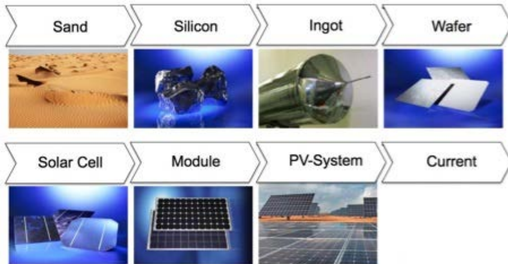
Figura 2.6 - Processo típico de produção de módulo solar de Silício cristalino.
