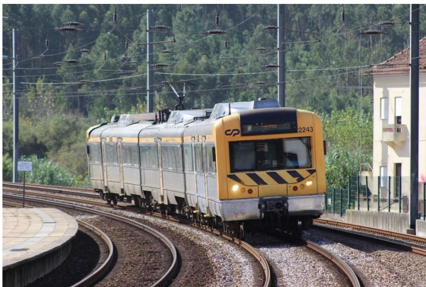
Figura 3.2 - Unidade Tripla Elétrica (UTE) série 2240 - Configuração em unidade simples. (Figura do autor Raul Marques)
