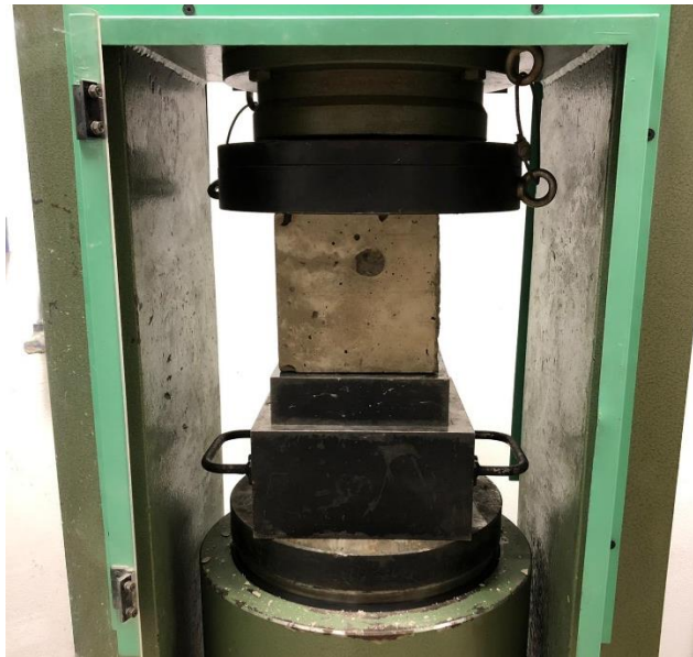
Figura 3.17 - Ensaio de resistência à compressão axial.
