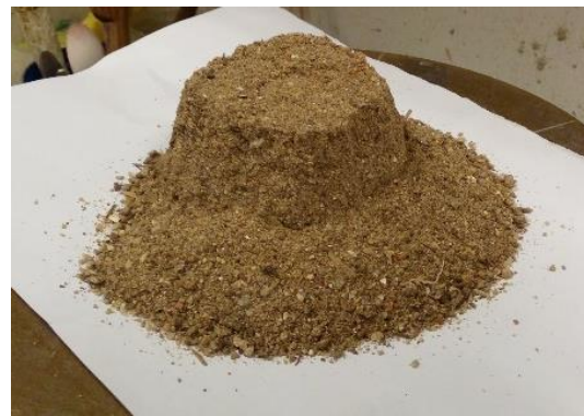
Figura 3.14- Agregado saturado com superfície seca após remoção do molde troncocónico.
