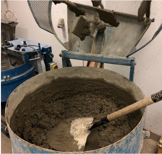
Figura 4.5 - Amassadura na betoneira.
