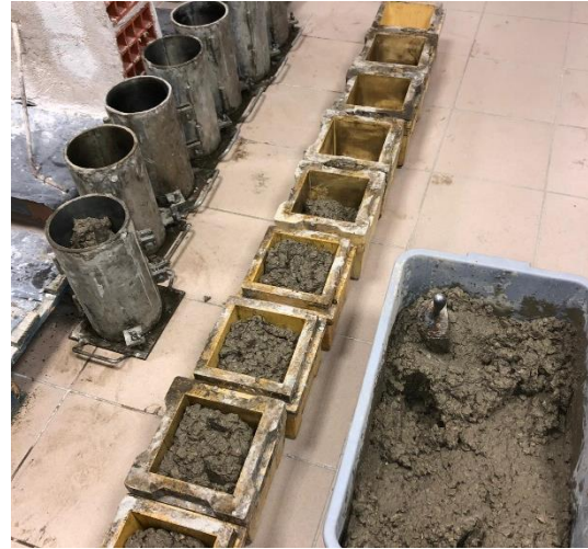
Figura 4.6 - Enchimento dos moldes.
