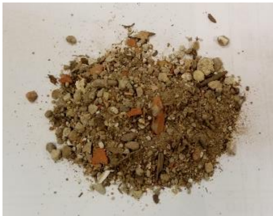
Figura 3.2- RCD fornecido pela SGR.
