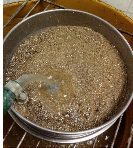
Figura 3.5- Aspeto dos AFR ao final da lavagem.
