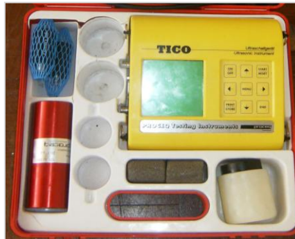
Figura 3.21 - Representação do conjunto de elementos indispensáveis ao funcionamento do ensaio ultra – sons.
