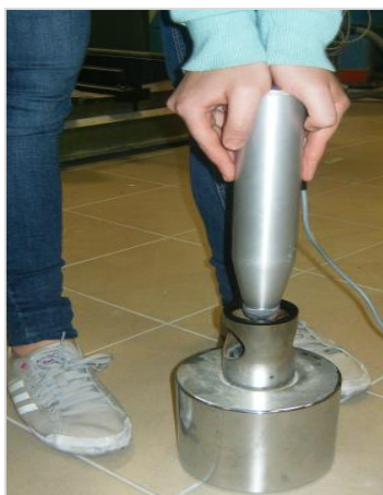
Figura 3.16 - Representação do teste de aferição do esclerómetro Schmidt do tipo N utilizado na inspeção do edifício em estudo.
