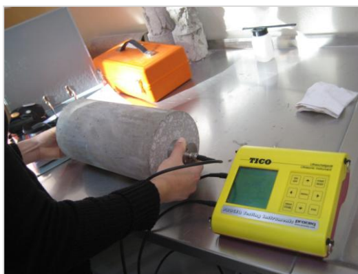
Figura 3.20 - Representação do aparelho ultra – sons (Sampaio, 2010).
