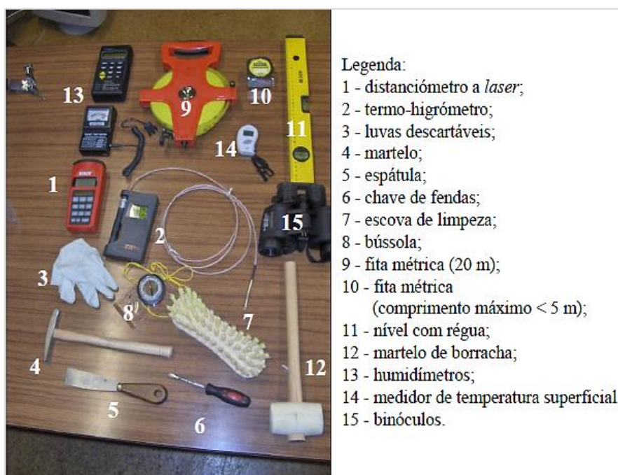
Figura 3.8 - Exemplo de meios auxiliares à avaliação in-situ (Flores-Colen, 2008).
