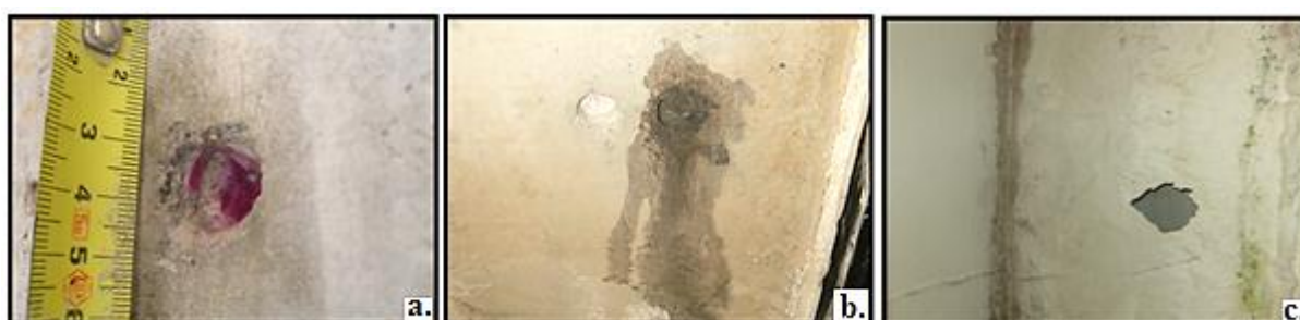
Figura 4.82 - a. Representação da superfície de betão armado após a realização do ensaio da fenolftaleína; b. Representação da superfície de betão armado após a colocação de nitrato de prata; c. Ocorrência da anomalia G.2.(3).
