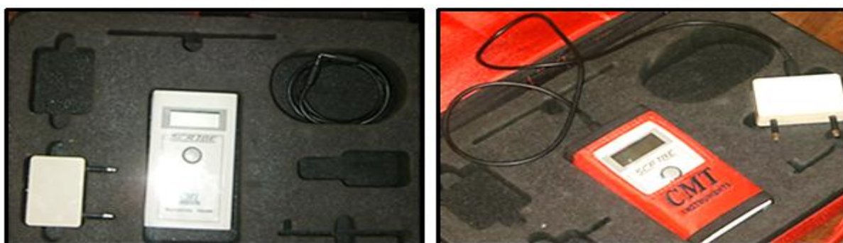
Figura 3.33 - Representação do medidor digital de resistividade elétrica utilizado durante as atividades de inspeção e diagnóstico em elementos de betão armado do edifício em estudo.
