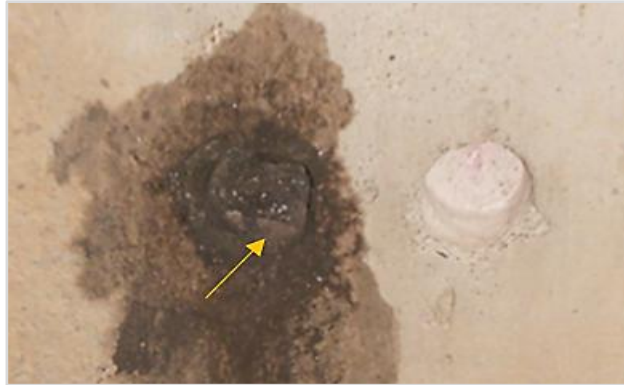
Figura 4.86 - Representação da formação de depósitos brancos no local do ensaio de aplicação de nitrato de prata.
