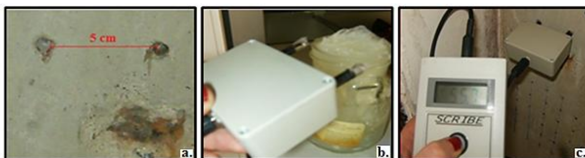
Figura 3.34 - Representação das três fases do ensaio de medição da resistividade elétrica, realizado no pilarete nº 2 do segundo piso: a. Realização da furação de dois orifícios com espaçamento de 5 cm; b. Colocação de vaselina nas duas sondas do aparelho; c. Colocação das duas sondas nos orifícios e leitura de dados obtidos.
