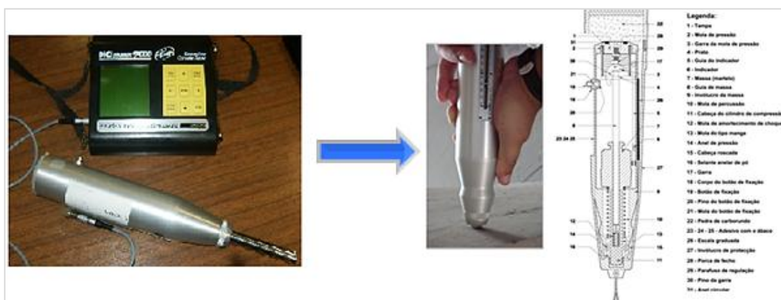
Figura 3.15 – Figura do lado esquerdo: Representação de um aparelho esclerómetro Schmidt do tipo N utilizado na inspeção ao edifício em estudo. Figura do lado direito: Representação da constituição de um esclerómetro Schmidt (adaptado de Córias, 2006).
