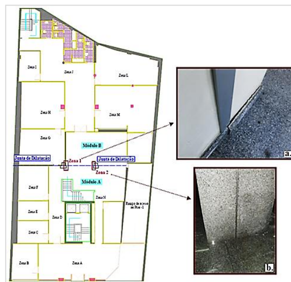
Figura 4.22 - Representação da divisão estrutural, através da realização de uma junta de dilatação no rés-do-chão.
