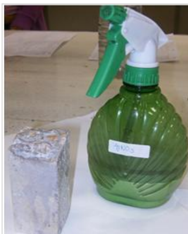
Figura 3.36 - Representação da amostra de solução de nitrato de prata utilizada para a verificação da presença de cloretos em certos elementos de betão armado, do edifício em estudo
