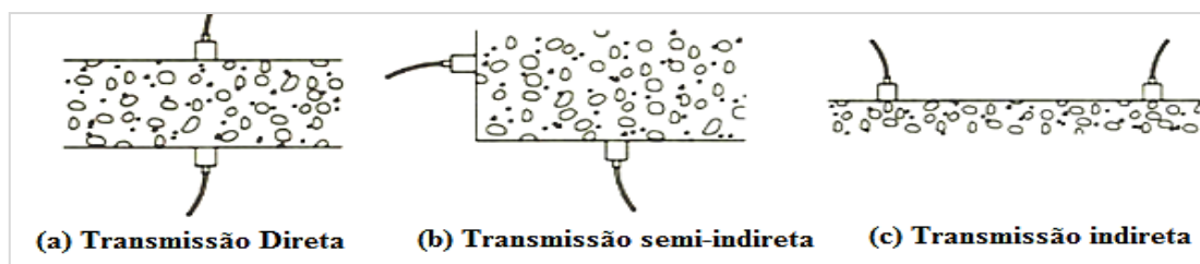
Figura 3.24 - Representação dos três métodos de medição de tempo de propagação das ondas ultrasónicas obtidos através do ensaio de ultra-sons (adaptado de Gonçalves, 2010).
