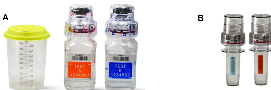
Figura 1.5- A- Frascos de colheita, transporte e armazenamento de amostras de urina com sistema de segurança. BEREG-kit, Berlinger B- Frascos de colheita, transporte e armazenamento de amostras de sangue com sistema de segurança. BEREG-kit Small, Berlinger
