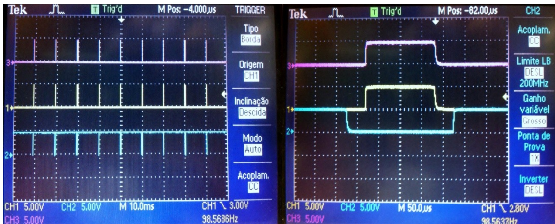
Figura 35: Formas de onda dos sinais de comando dos Behlke : Behlke1 (azul), Behlkes2 e 3 (amarelo e roxo)
