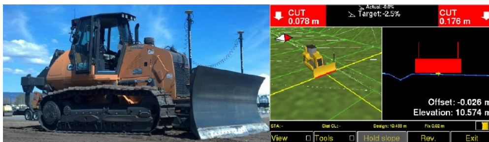
Figura 2-41 – Tecnologia de controlo 3D de modelo “SP. iGD3 - iGD4SP Leica iCONE” [20]
