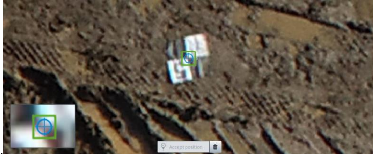
Figura 2-26 – Associação de coordenadas do Ponto de Controle Terrestre visível na imagem (iTwin Capture Modeler – Bentley)
