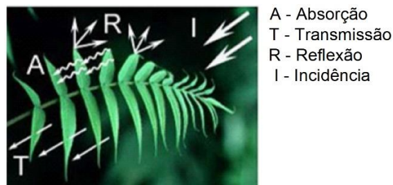
Figura 2-12 – Interação com a superfície terrestre (adaptado de [12])
