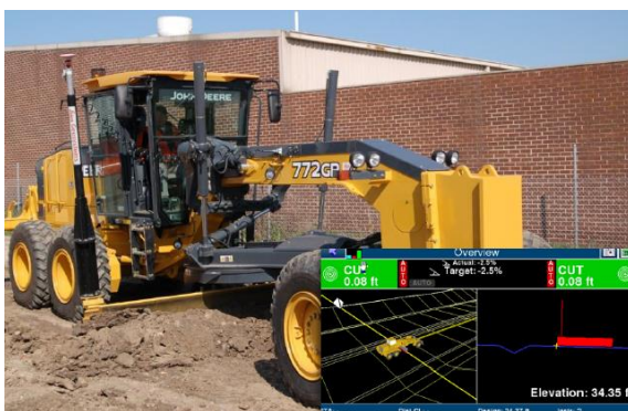
Figura 2-42 – Sistema 3D de modelo “iCON Grade” para motoniveladoras [20]
