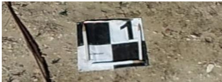
Figura 2-22 – Exemplo de ponto de controle terrestre
