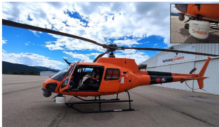
Figura 2-32 – Sistema LiDAR - Integração num helicóptero tripulado [22]
