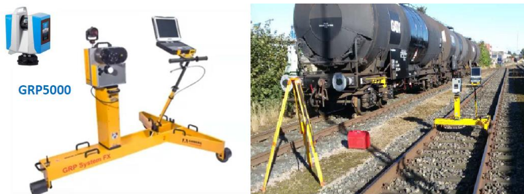
Figura 2-52 – Sistema AMBERG FX GRP 5000 com Laser Scanner [28]
