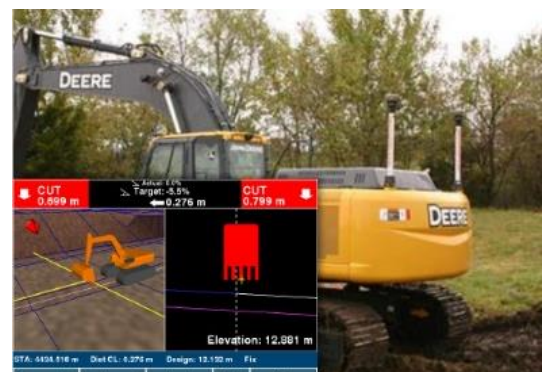
Figura 2-43 – Sistema 3D de controle de escavadoras de modelo “iCON excavate iCP41” [20]
