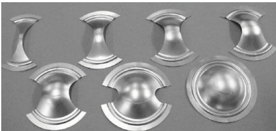
Figura 7 – Diferentes geometrias de provetes utilizados no ensaio de Nakajima [8].
