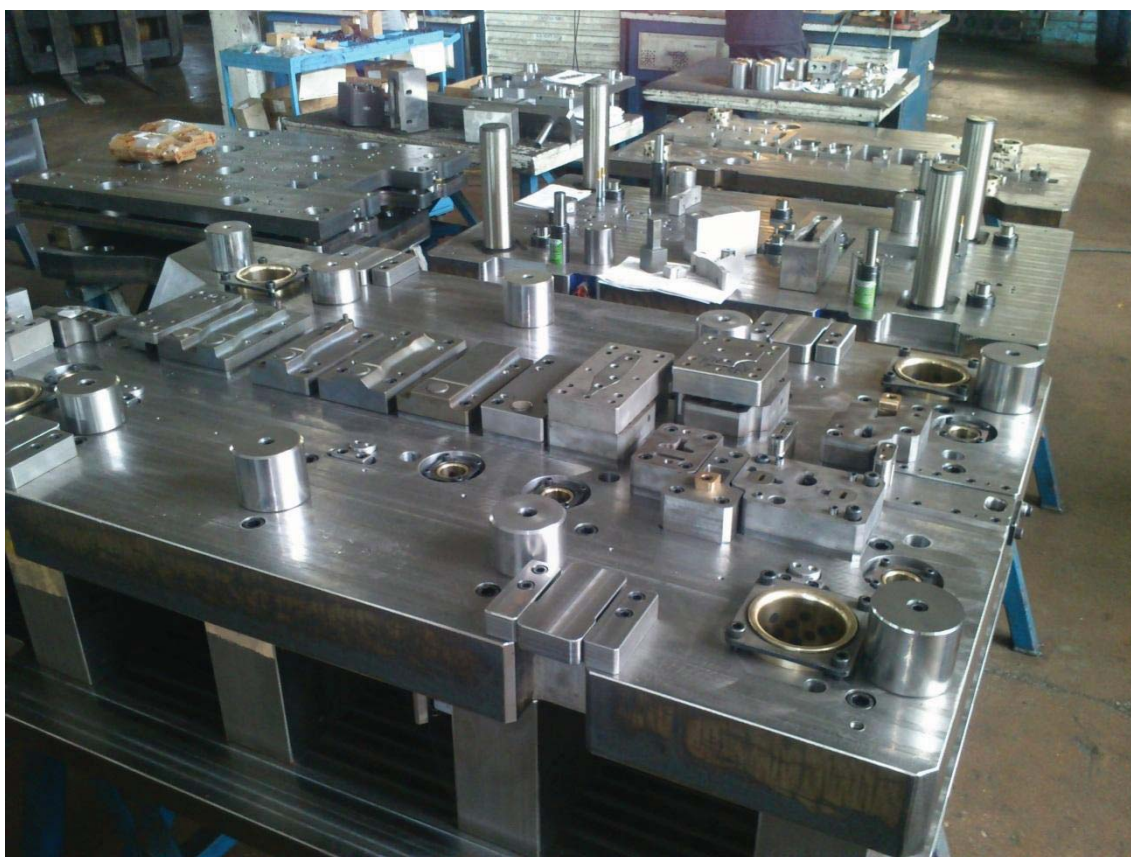
Figura 43 – Aspeto da ferramenta após montagem.
