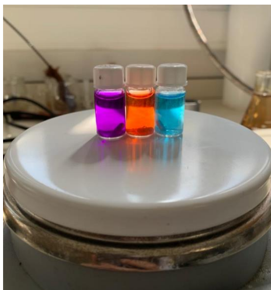
Figura 2.12. Exemplo de um ensaio de Adsorção (HKUST-1 com MV, CR e MB, respetivamente).
