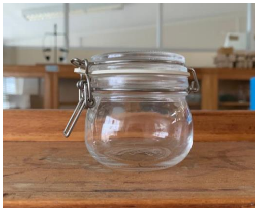
Figura 2.11. Frasco de vidro utilizado para a secagem de membranas.
