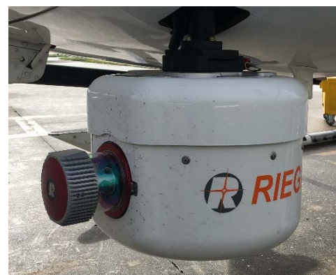
Figura 3.2 - Pod LiDAR instalado num helicóptero
