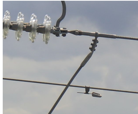
Figura 3.7 - Amortecedor Stockbridge partido
