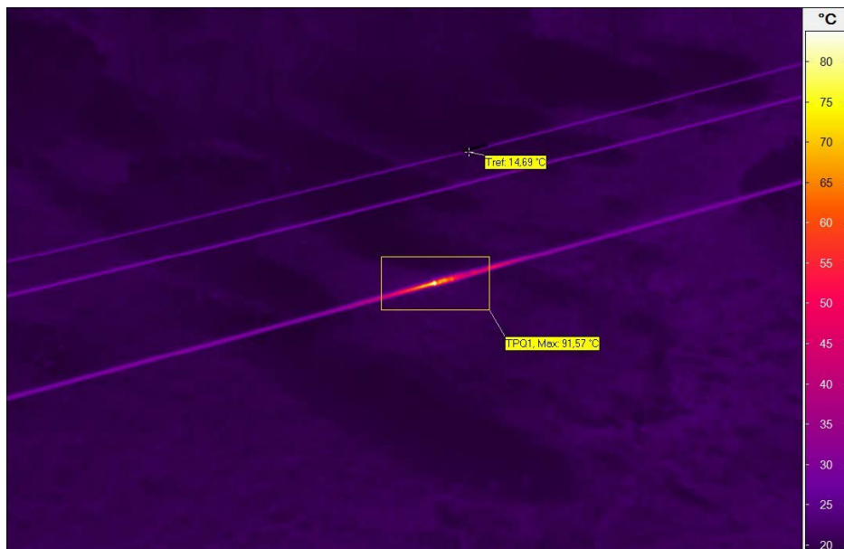
Figura 3.21 - Ponto quente em união
