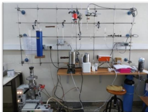
Figura 16 – Instalação experimental para determinação de isotérmicas de adsorção com azoto. Inclui uma linha de vácuo em vidro, válvulas de estanquicidade e sensores de pressão.
