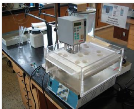
Figura 22 - Montagem de termostatização e homogeneização utilizada no trabalho laboratorial para ensaios de adsorção.
