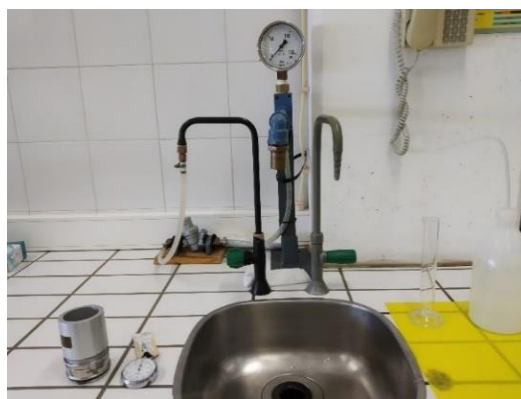
Figura 17 – Montagem para determinação da finura via húmida das CVC, de acordo com a norma EN 451-2. 91
