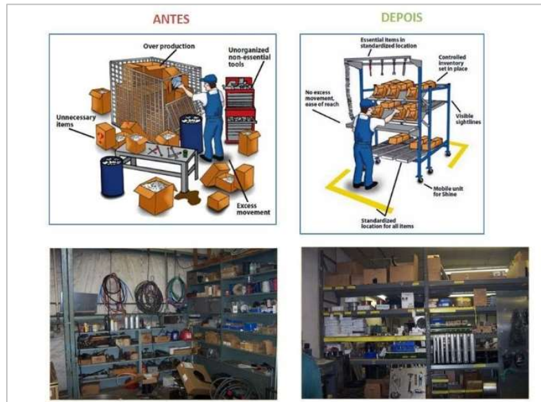
Figura 5-3 -Exemplo de limpeza e organização do posto de trabalho e zonas de arrumação ( website LEANBOX, 2022 )
