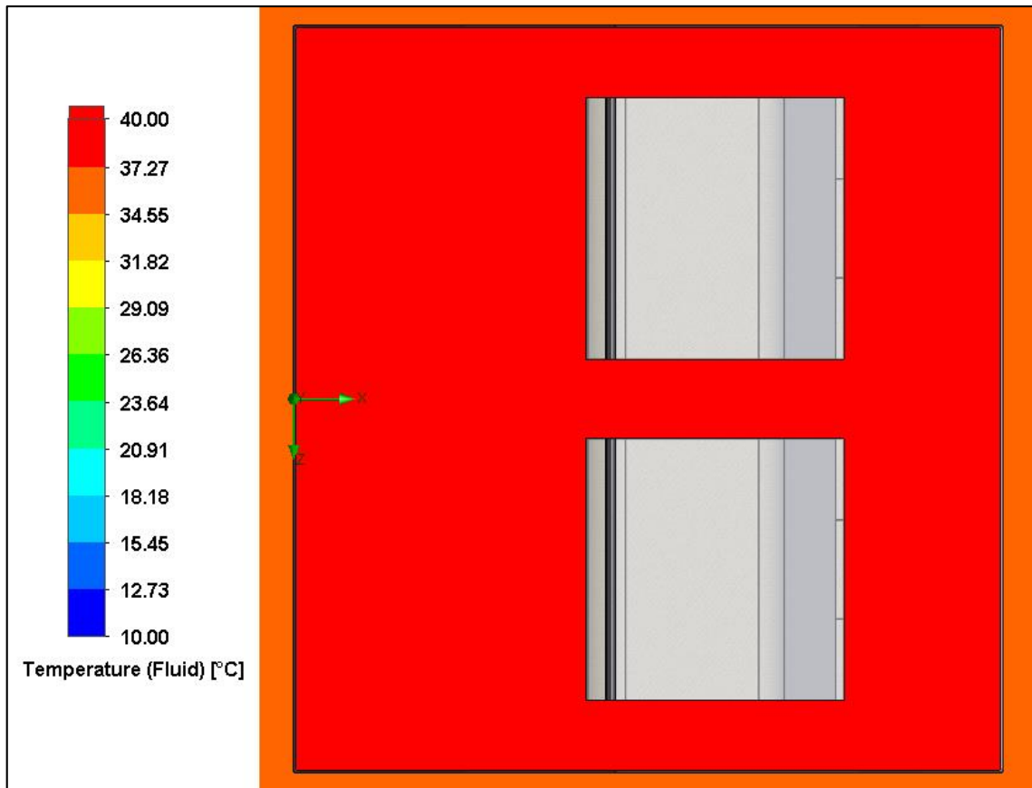
Variação da temperatura do ar no interior do HA para 1 s, ao nível dos pés [Y=0,018 m].
