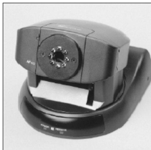
Figura 1: Pesquisador visual ( eye tracker ) modelo ASL 504 18
