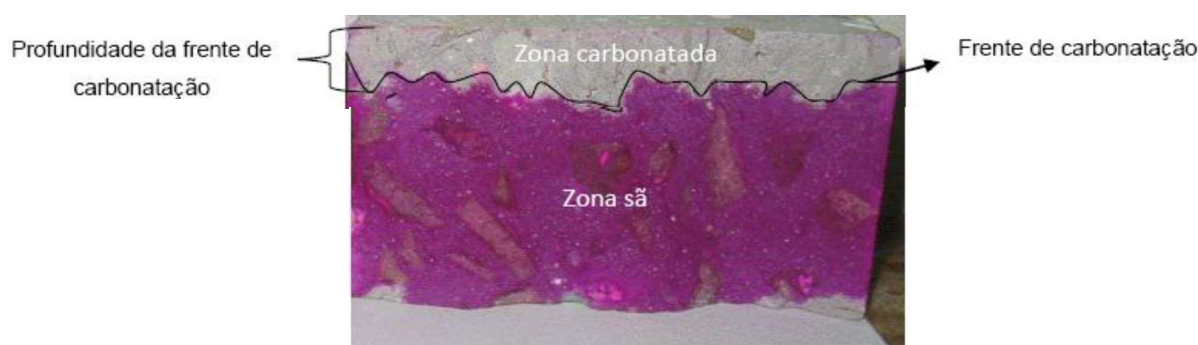
Figura 7 - Corpo de prova após aspersão da fenolftaleína
