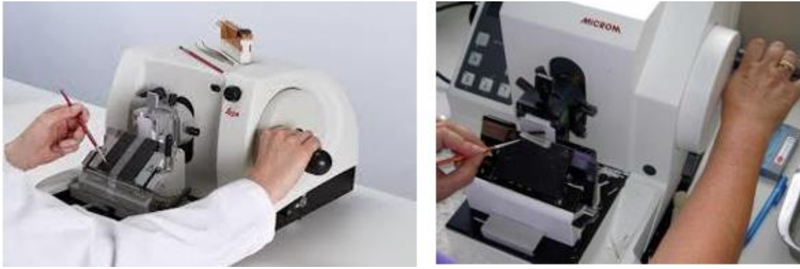
Figura 2.1 – Movimento repetitivo manual efetuado pelo técnico durante a microtomia – Micrótomo de Minot. Adaptado de (5).
