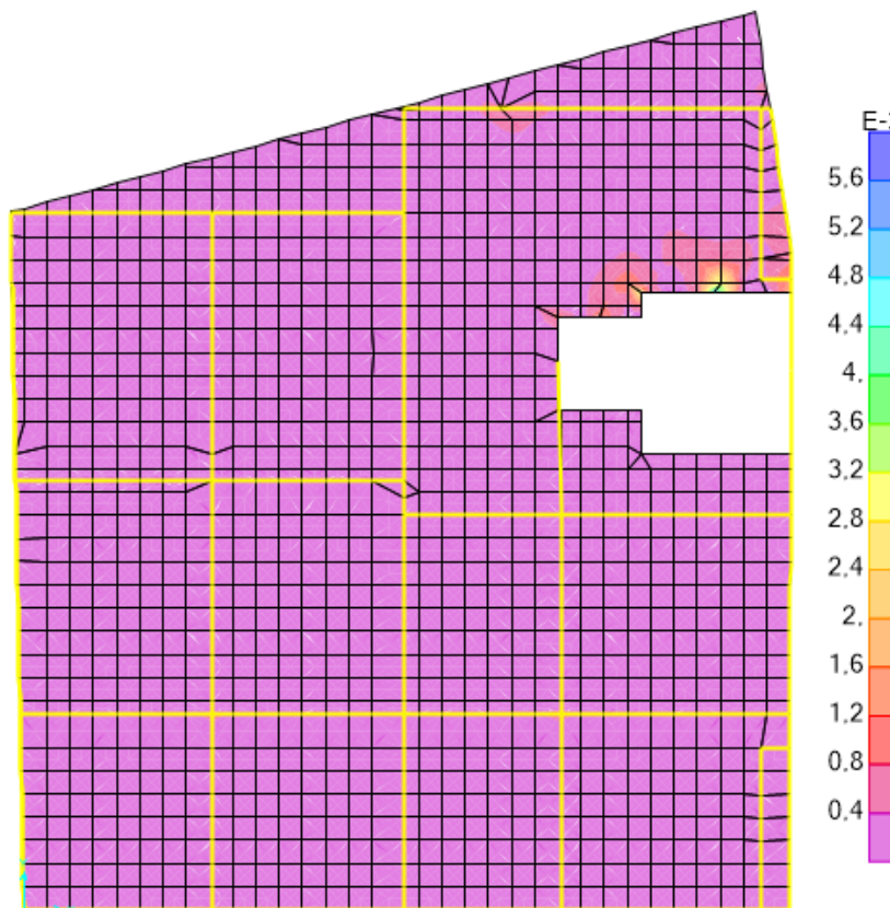
Figura 11. 20 - Área de armadura superior do piso 3, segundo a direção y (em metros)
