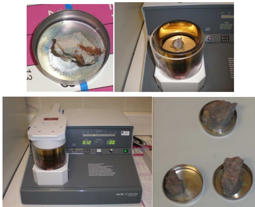
Figura 39 – Preparação das amostras para visualização no MEV-EDS.
