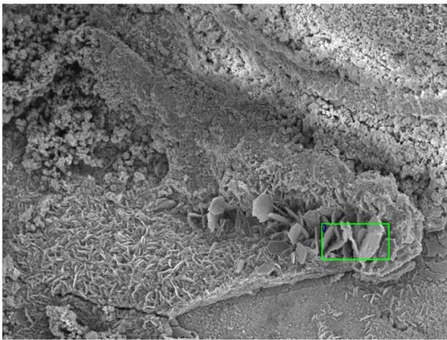
Micrografia da superfície betão adjacente à armadura em modo ES
