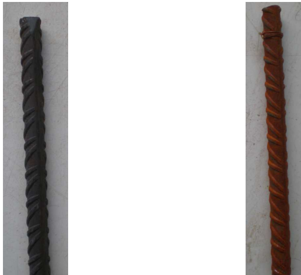
Varões de aço antes do pré-tratamento Varões de aço após o pré-tratamento
