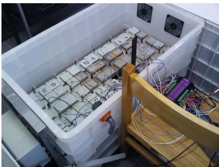
Figura 28 – Ensaio de exposição à solução de cloretos.
