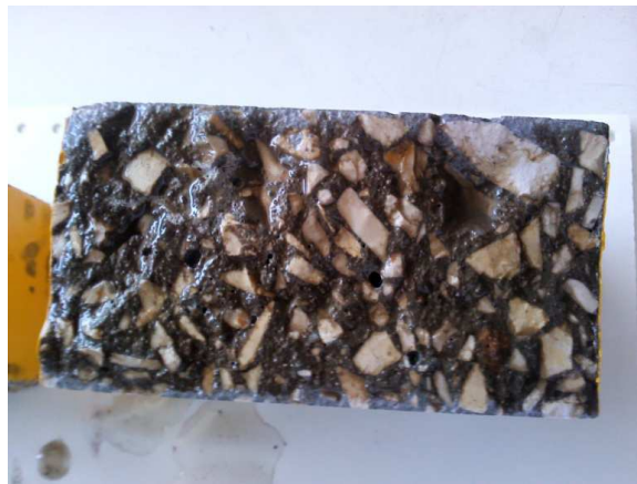
Figura 27 – Fotografia de um “dummy” após o ensaio colorimétrico.
