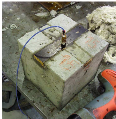
Figura 22 - Provetes de betão armado após desmoldagem.
