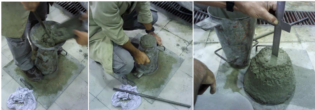
Figura 20 – Ensaio de abaixamento.
