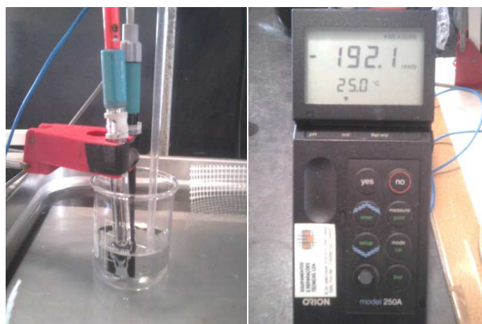
Figura 37 – Medida do valor de potencial numa amostra por potenciometria directa.
