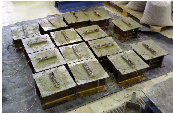
Figura 21 – Provetes de betão armado após compactação.
