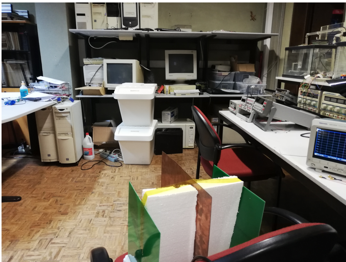
Figura 64: Ambiente de teste para o cancelamento de auto-interferência
