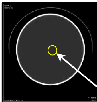
Figura 19 - Região de interesse para a avaliação do ruído em TC segundo a [IAEA]
