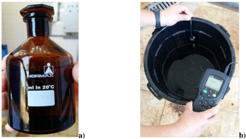
Figura 46 – Frasco de Winkler a) fotografia, b) recipiente para manutenção da temperatura
