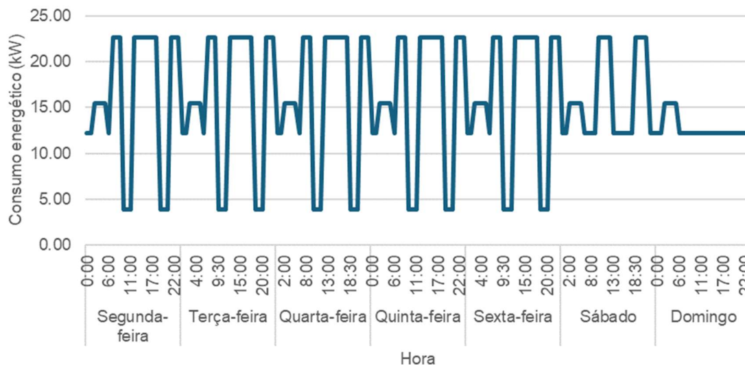
Figura 5.37 - Diagrama de carga diário de março 2023 para o Parque de Campismo do Forte do Cavallo (Obtido através dos dados das tabelas 5, 6 e 7 do anexo IV)
