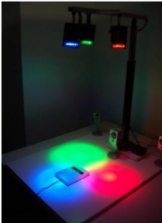
Figura 9 – Sistema de som musical baseado em cores RGB
