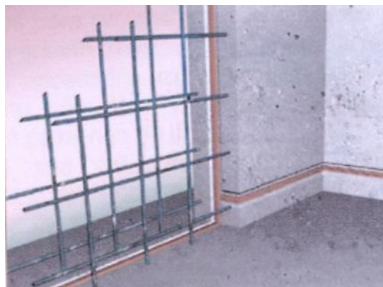
Fig. 39 - Perfis hidro-expansivos em juntas de betonagem [23]
