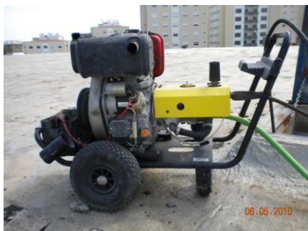
Fig. 82 - Máquina de jacto de água a alta pressão [17]
