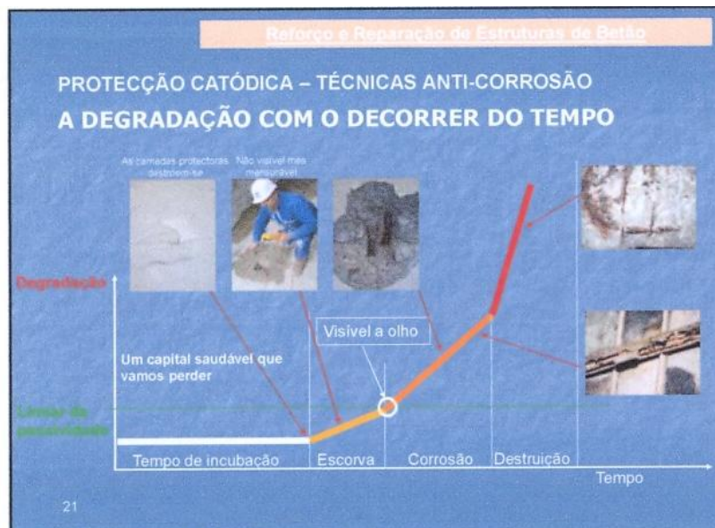
Fig. 64 – Desagregação do betão ao longo do tempo
