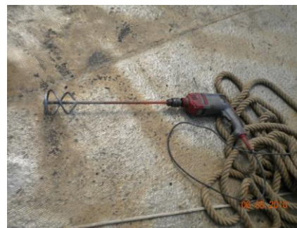
Fig. 83 - Misturadora eléctrica para confecção de argamassas [17]
