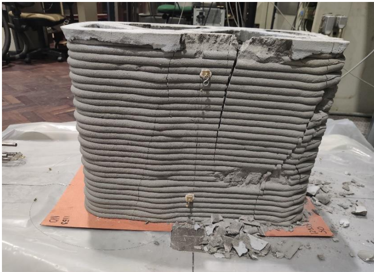
Figura 5.15 - Modelo 2 após ensaio com pormenores do mecanismo de rotura obtido
