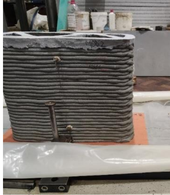
Figura 4.40 - Instrumentação deslocalizada do Modelo 1 - vista lateral
