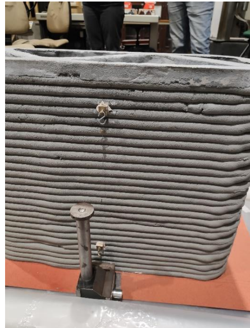
Figura 4.42 - Instrumentação deslocalizada do Modelo 2 - vista lateral
