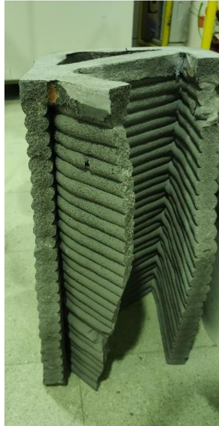
Figura 5.11 - Corte vertical da parede Modelo 1
