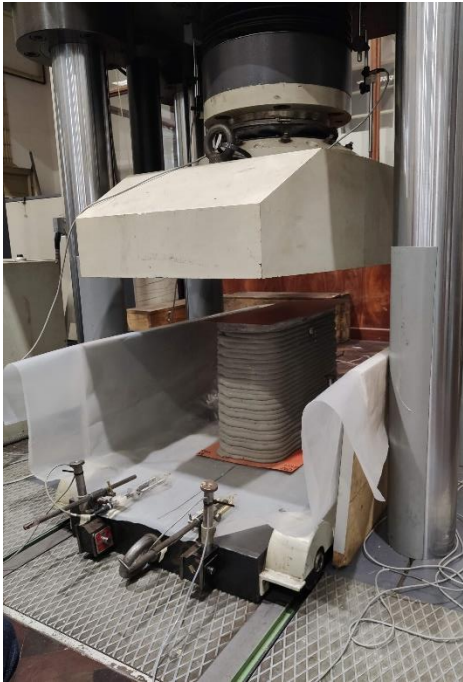
Figura 5.7 - Parede Modelo 1 instrumentada preparada para ensaio
