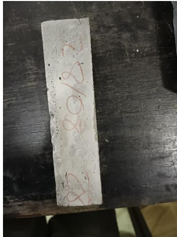
Figura 4.18 - Exemplo de provete da amassadura da argamassa da parede Modelo 3
