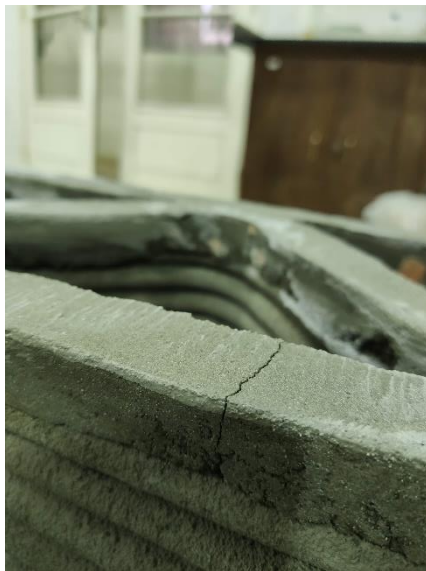
Figura 4.23 - Fendas de retração no Modelo 1
