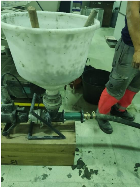
Figura 4.3 - Funil com instrumentos de ajuda de encaminhamento de argamassa
