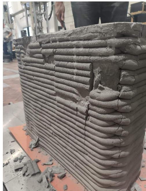
Figura 5.4 - Modelo 0 após ensaio e respetivo mecanismo de rotura
