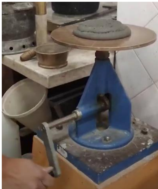
Figura 4.17 - Ensaio de espalhamento de argamassa cimentícia
