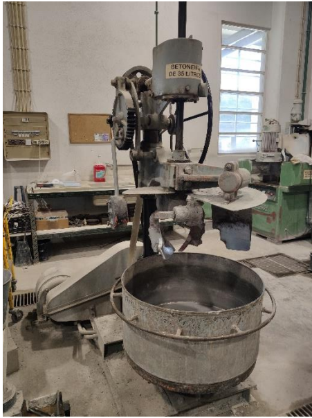
Figura 4.5 - Betoneira de 35 Litros utilizada na amassadura da argamassa usada nas impressões 3D
