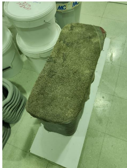
Figura 4.24 - Cura húmida do Modelo 1
