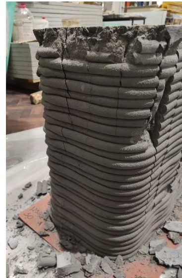
Figura 5.15 - Modelo 2 após ensaio com pormenores do mecanismo de rotura obtido
