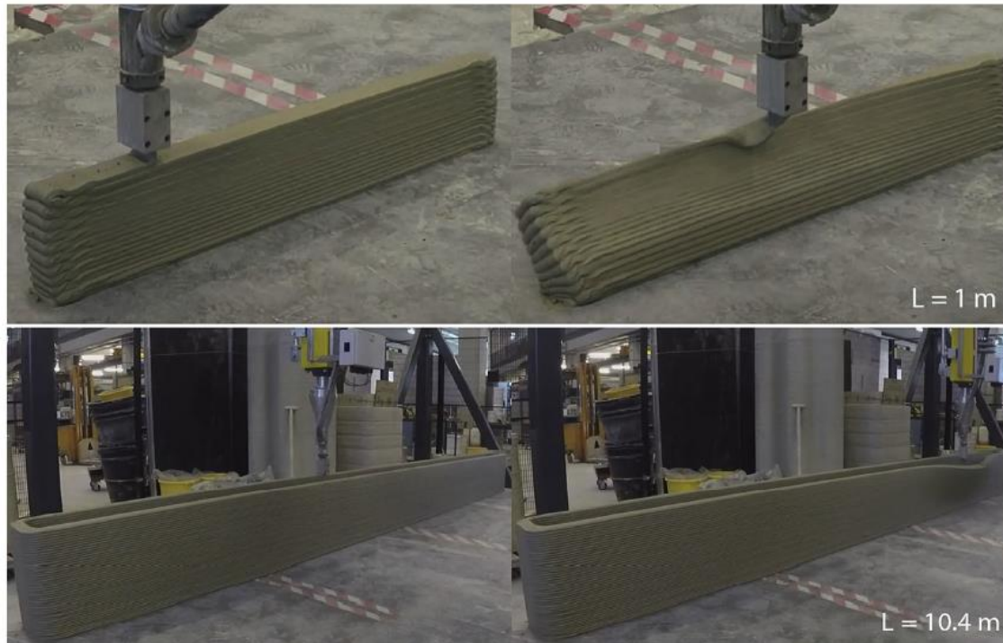
Figura 2.1 - Paredes impressas de 1 e 10 metros antes e depois de rotura plástica (Wolfs et al. , 2019)
