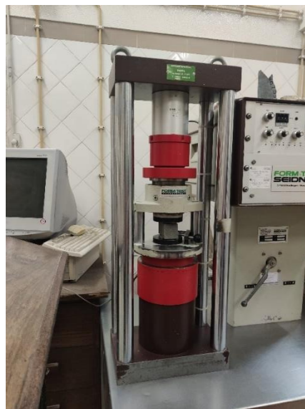
Figura 4.20 - Ensaio de provete à resistência à compressão no equipamento Form+Test Seidner
