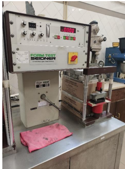
Figura 4.19 - Ensaio de provete à resistência de flexão no equipamento Form+Test Seidner
