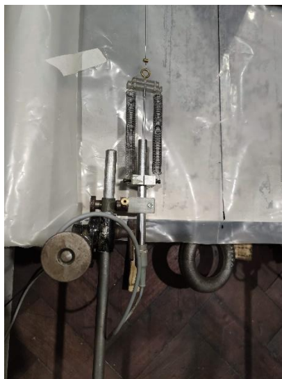
Figura 4.37 - Transdutor montado em apoio de instrumentação
