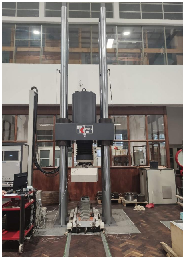
Figura 4.47 -Prensa MFL UPS 5000V utilizada no ensaio de resistência à compressão
