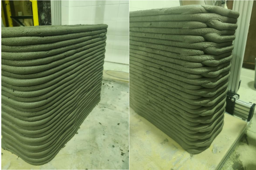
Figura 3.5 – Excentricidades entre camadas pares e ímpares e ponto de transição no Modelo 1
