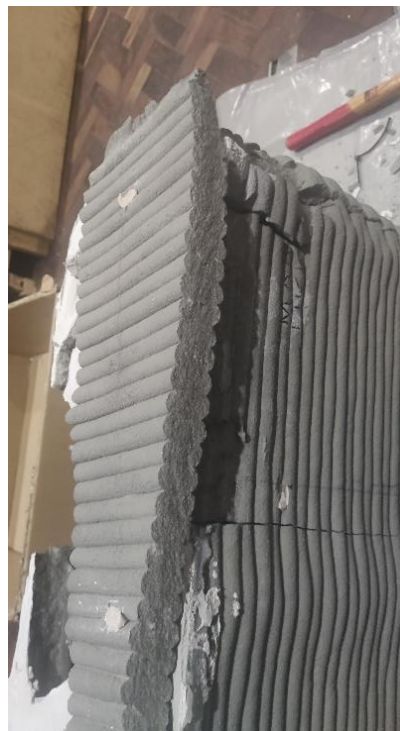
Figura 5.26 - Destacamento de parte do modelo 3 para leitura de largura de camadas
