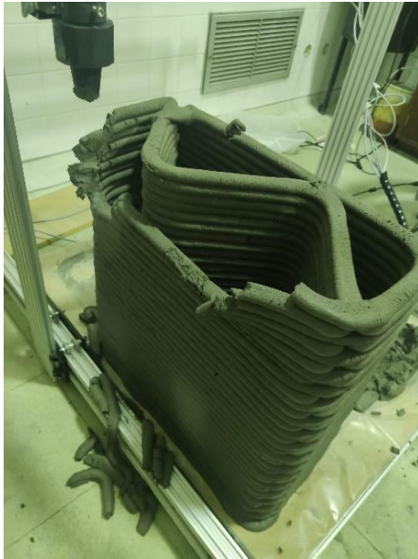
Figura 4.9 - Derrubamento de parte da Parede Modelo 1
