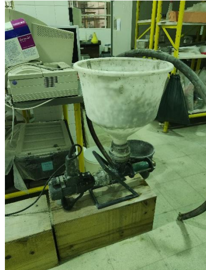
Figura 3.8 - Bomba, rotor, funil e mangueira de impressora 3D
