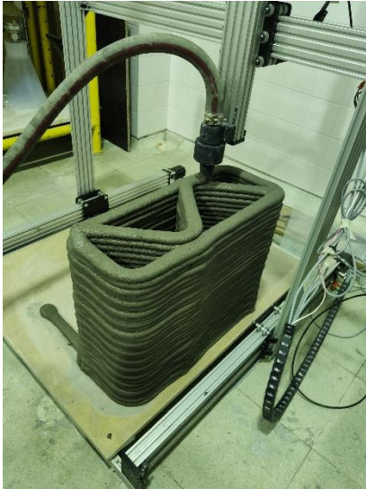
Figura 3.7 - Pórtico, mangueira e sistema de bocal da impressora 3D
