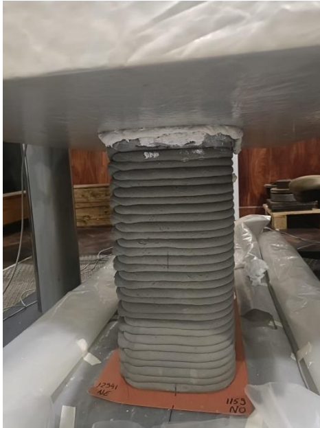
Figura 4.35 - Segunda Regularização do Modelo 3, vista de frente
