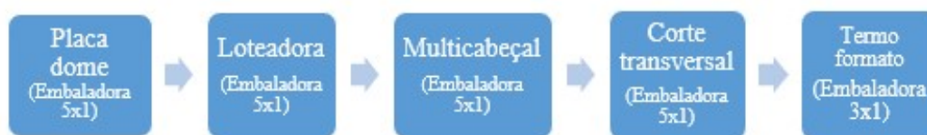
Figura 4.32 – Ordem de intervenção de cada componente de acordo com o NPR. Fonte: Elaboração própria.
