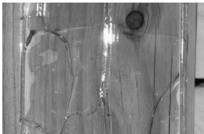
Figura 92 – Consequências da expansão tangencial da madeira no vidro (34)
