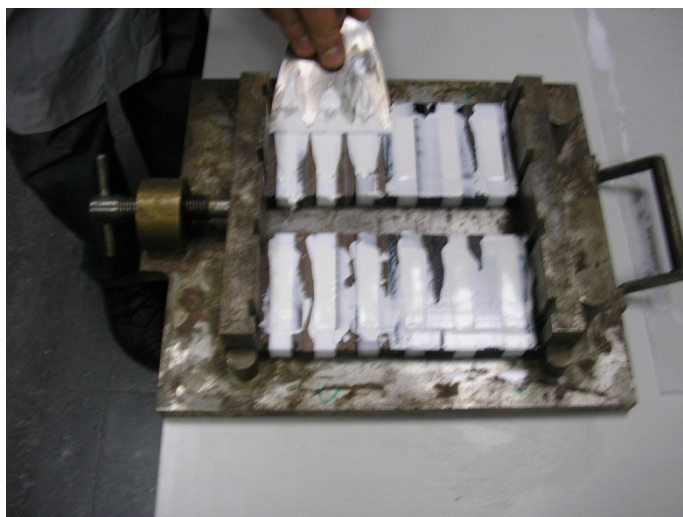
Figura 80 – Alisamento da superfície dos provetes
