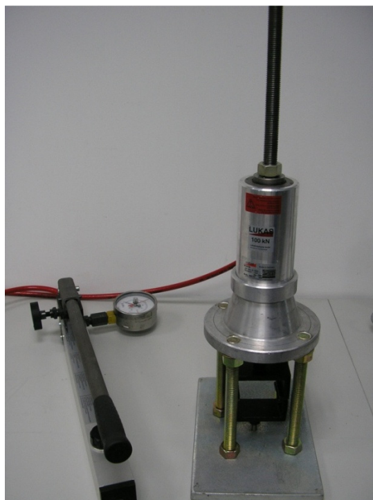
Figura 82 – Equipamento utilizado na realização dos ensaios de tracção
