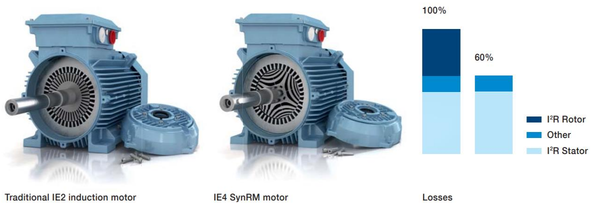
Figura 2.8- Comparação das perdas entre o IM e do SynRM [37].
