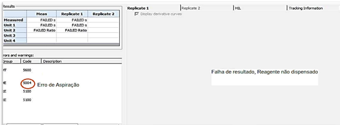
Figura 5.7- Resultado Indeterminado por erro de aspiração. Fonte: ULS S. José
