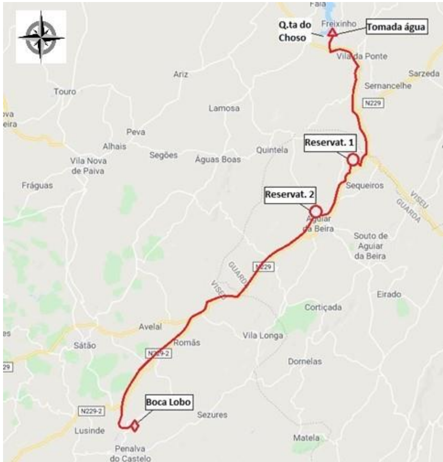
Figura 21 – Pormenor da implantação do traçado do sistema com as 2EE.
