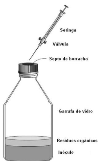
Figura 29 - Procedimento da medição do volume de biogás (HANSEN et al. , 2003)
