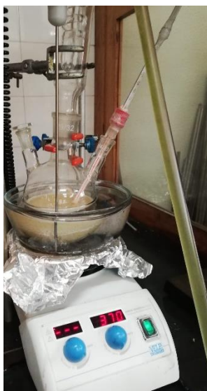
Figura 41 – Montagem de transesterificação com reator aquecido por banho de óleo
