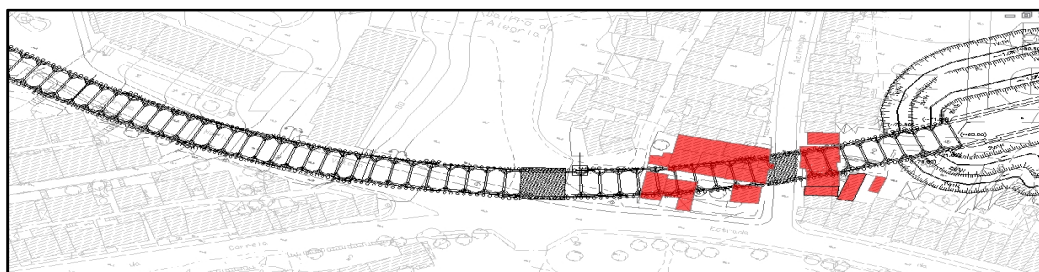
Figura 4.13 - Planta troço 72 (localização das habitações demolidas).
