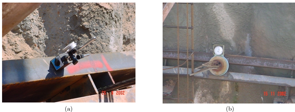
Figura 4.26 - (a) Medição do deslocamento relativo da XX; (b) Célula de carga.
