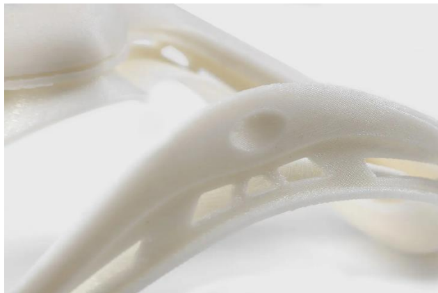
Figura 2.2 – Exemplo de uma armação de óculos de ski impressa por FDM (Formlabs Form 3 desktop SLA 3D printer)
