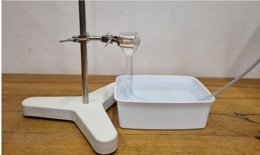
Figura 26 – Sistema de medição e armazenamento de Hidrogénio
