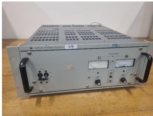
Figura 24 – Fonte de Energia elétrica - KEPCO Power Supply
