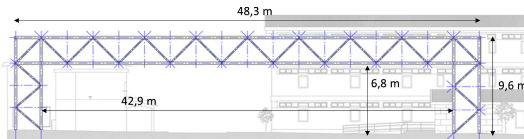
Figura 1.3 – Alçado norte da estrutura do Passadiço metálico [4].
