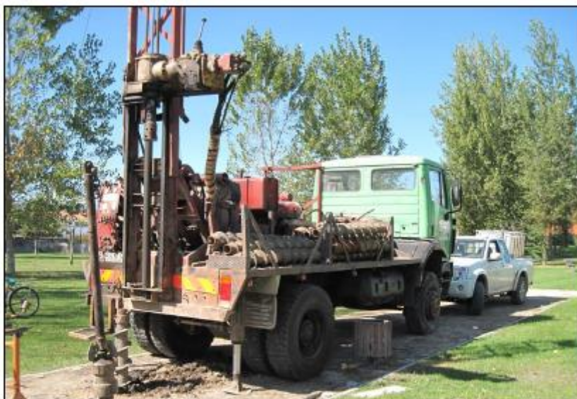
Figura 2.1 – Sonda de perfuração Mobile Drill B47-HD, montada sobre UNIMOG e esquema dos trados.
