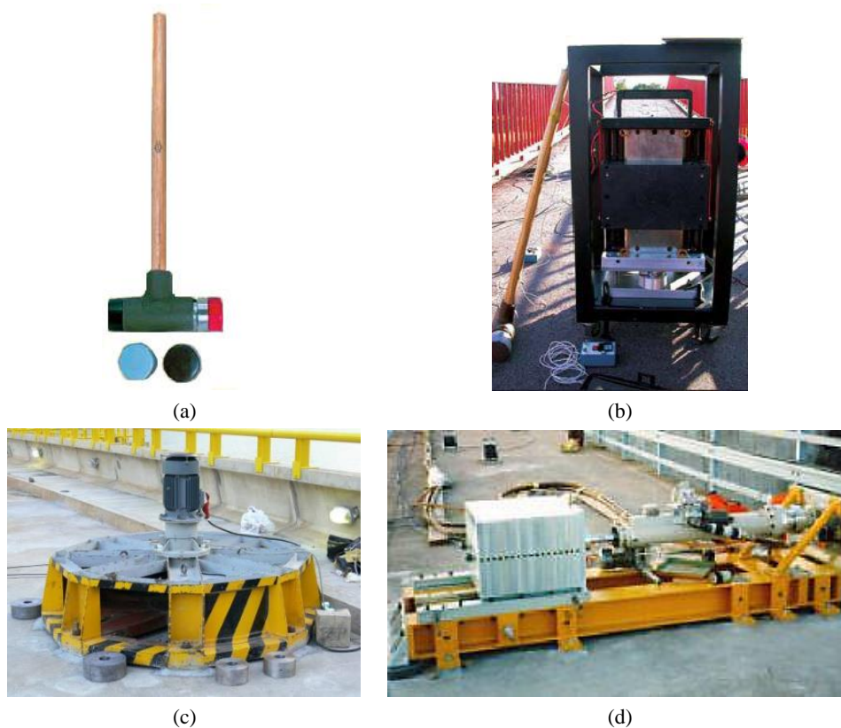
Figura 3.1 – Vibradores: a) martelo de impulsos; b) eletromecânico; c) rotativos de massa excêntrica com motor elétrico (LNEC); d) de translação com motor servo-hidráulico (EMPA).
