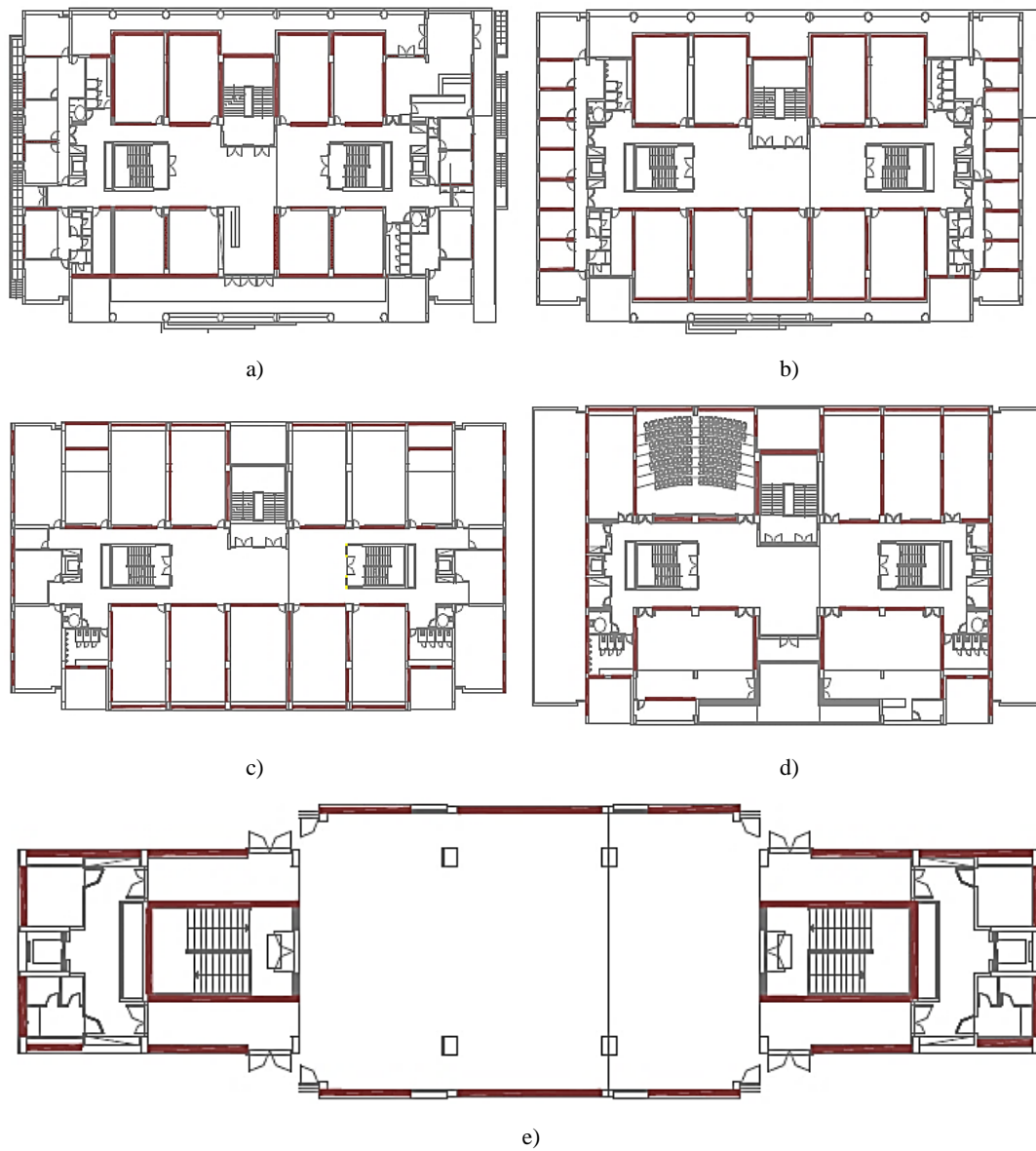
Figura 6.17 – Plantas arquitectónicas com disposição dos painéis de alvenaria: a) piso 0; b) piso 1; c) piso 2; d) piso 3; e) piso 4.
