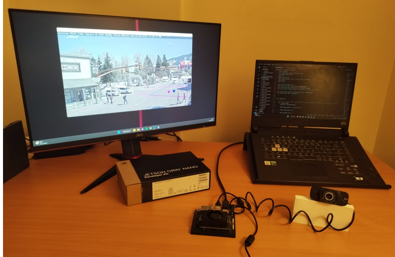
Figura 4.1: Recursos hardware utilizados para implementar e testar o protótipo do sistema de detecção de RLR. A plataforma NVIDIA com a câmara simula o sistema embebido operando nos cruzamentos.
