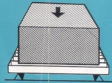
Direcção das lâminas principais de resistência.
