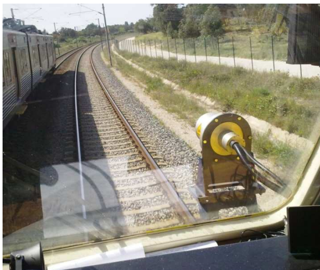
Figura 6 - Sistema de laser – radar integrado na traseira no veículo de inspeção EM-120
