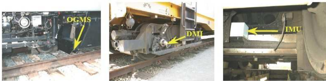
Figura 4 – POS instalação de hardware: instalação OGMS (à esquerda) e Instalação IMU (à direita). Retirada do seguinte documento (Mostafa, Hutton, Reid, & Hill, 2001)
