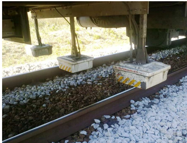
Figura 9 – Três antenas do Geo-Radar localizadas no centro do chassis da EM 120
