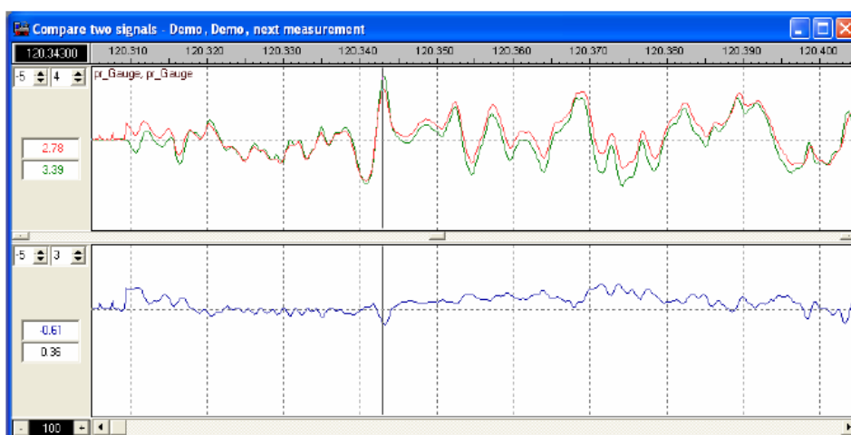
Figura 36 – Comparação de dois sinais relativos à medição da Bitola
