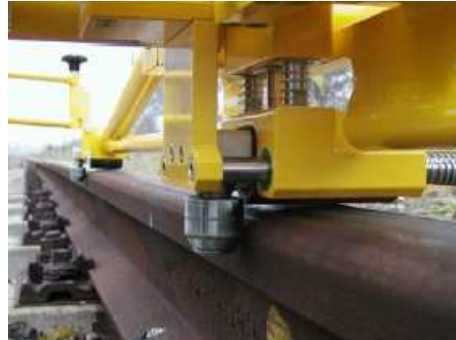
Figura 20 – Rodas do Krab e roletes de cabeça de carril
