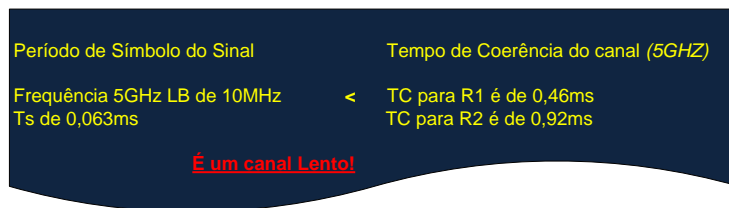
Figura 51 – Caracterização do canal relativamente ao desvanecimento baseado em desvio de Doppler (Técnica C)
