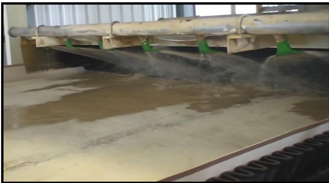
Figura 49: Processo de lavagem e desidratação do gesso a passar no tapete. Fonte: (Albuquerque, 2009).
